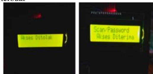
Gambar 5 Hasil Pengujian RFID pada LCD Berdasarkan gambar 5 diatas, Ketika kartu yang kita tag pada RFID terdaftar maka
